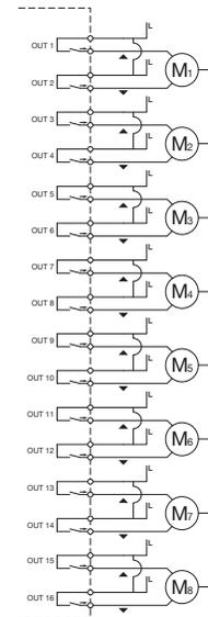
Configurazione fan coil 2 tubi / 3 velocità
